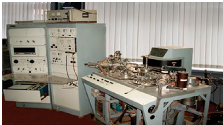
Sirt ionlanishini o'rganish uchun modernizatsiya qilingan MI-1201V mass-spektrometri
