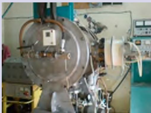
Titan nitridi mustahkamlovchi qoplamalarni ion-bombardimon yordamida ion-plazma usuli bilan cho'kmasi va sintezi uchun mo'ljallangan texnologik qurilma.
