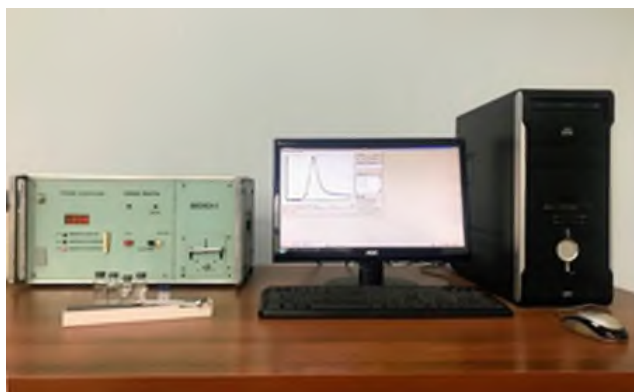
“Iskovich” termodesorbsiyali sirt-ionlanishli o'lchov kompleksi.
