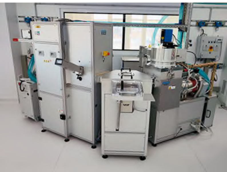
O'sish qurilmasi – vakuumli yuklash shlyuzi bilan jihozlangan atom qatlamli, kimyoviy va plazmokimyoviy cho'kindi hosil qilish uskunasi (PEALD, PECVD).
